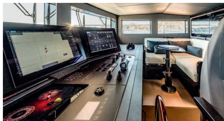
Erhöht: Die integrierte Brücke von Telemar nimmt wenig Platz im kompakten Ruderhaus ein. Eine Tür führt auf das Sundeck, ein Niedergang in die Pantry.
